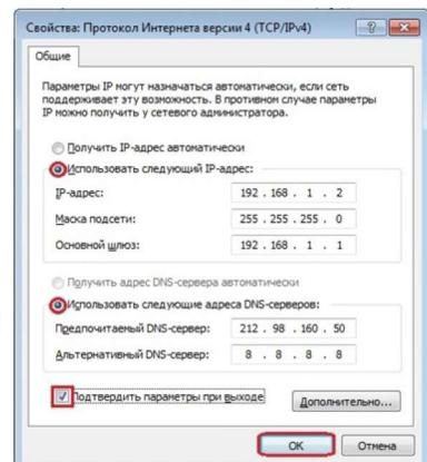
После того как все параметры введены, ставим галочку напротив «Подтвердить параметры при выходе». Нажимаем «OK» в Свойствах Протокола и «OK» в Свойствах подключения для сохранения настроек.
